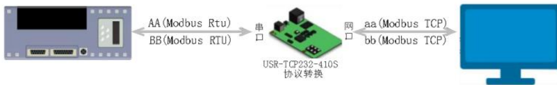
图 41 Modbus TCP/RTU 转换
